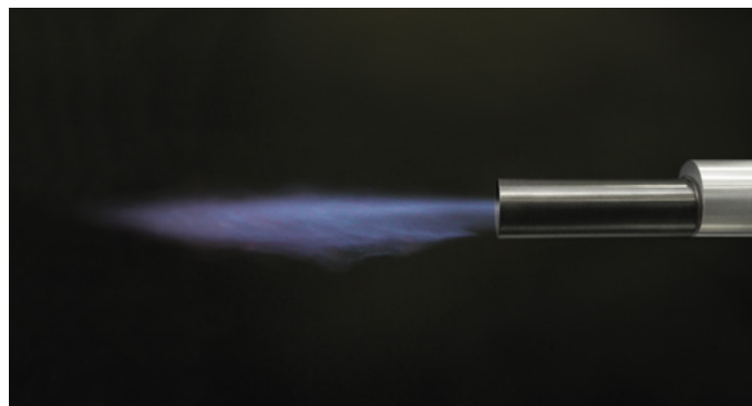
Flamme du ZKIH en combustion ouverte en fonctionnement avec du gaz naturel
