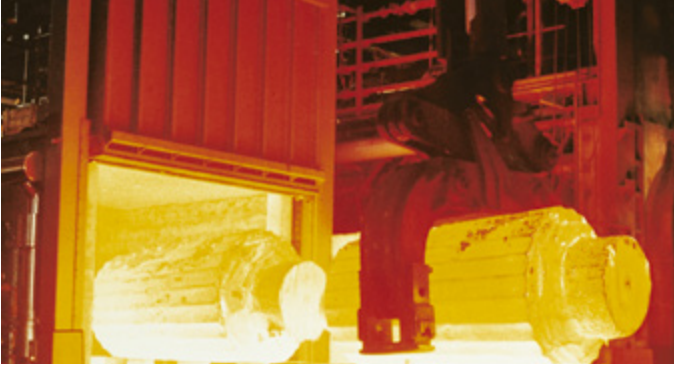
Wagenherd-Schmeldeofen in der Metallindustrie
