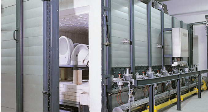
Industrie de la céramique : four à sole mobile
