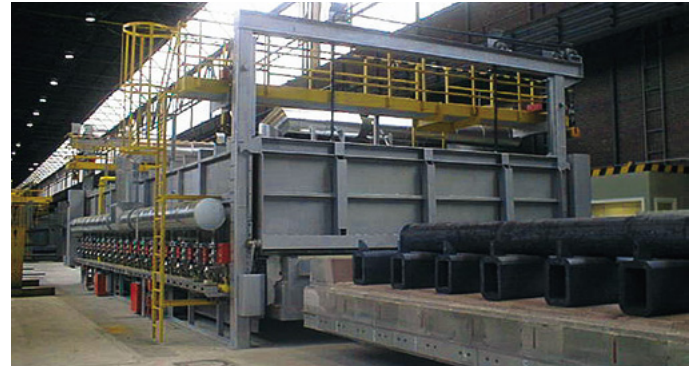
Industrie métallurgique : four à sole mobile
