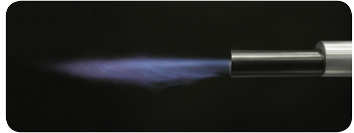
Flamme des ZKIH bei Erdgasbetrieb im Freibrand
