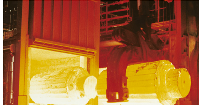
Wagenherd-Schmiedeofen in der Metallindustrie
